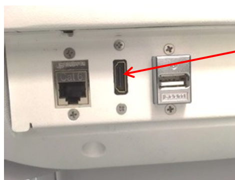
Afbeelding 11: Poort (HDMI) voor tweede beeldscherm
