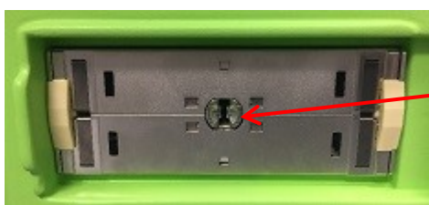
Afbeelding 20: Vergrendelgroef op de transducerconnectorsleuf
