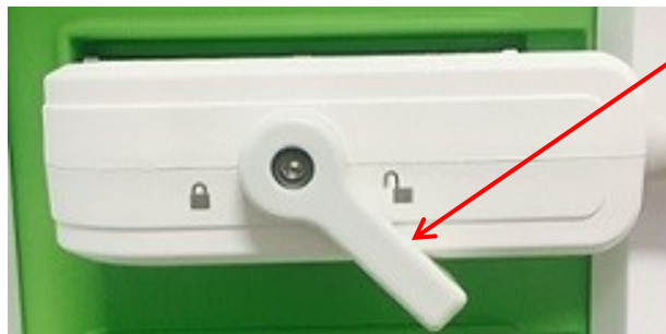
Afbeelding 30: Vergrendelknop transducerconnector in ontgrendelde stand
