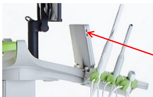
Afbeelding 7: USB-poorten aan de linkerkant van het aanraakscherm
