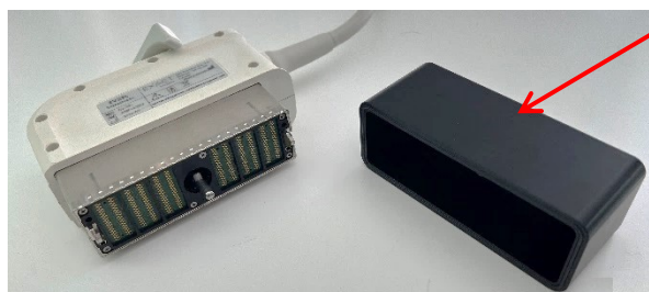
Afbeelding 32: Vergendelbare afdekking van transducerconnector
